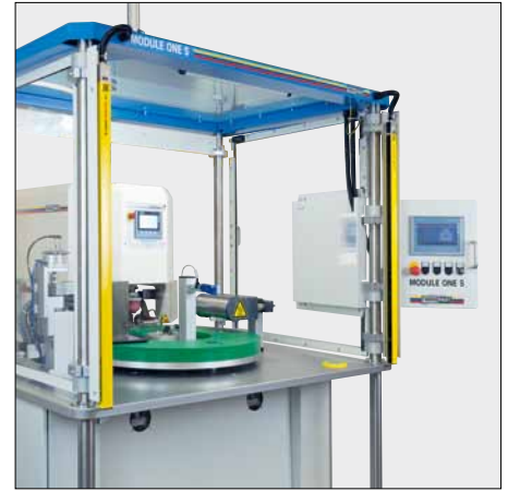
Ergonomisch: Benutzerfreundliche, schwenkbare Bedienkonsole (integriert in Seitentüre)
